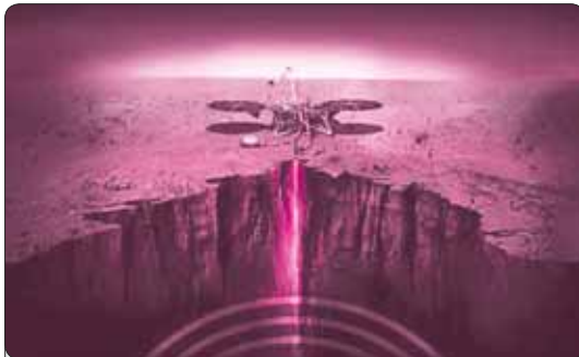
▲ دستگاه‌های لرزه‌نگار، کاوشگرهای جریان گرما و زمین‌سنج‌های این سطح‌نشین اطلاعات خود را به زمین مخابره خواهند کرد.
